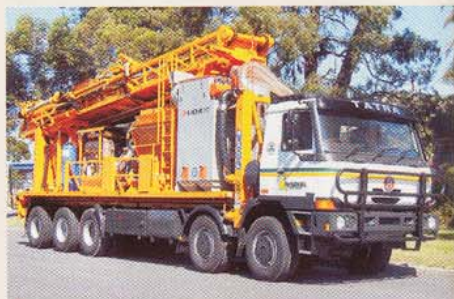
Vrtná souprava firmy Ausdrill na podvozku T815 10x8.
